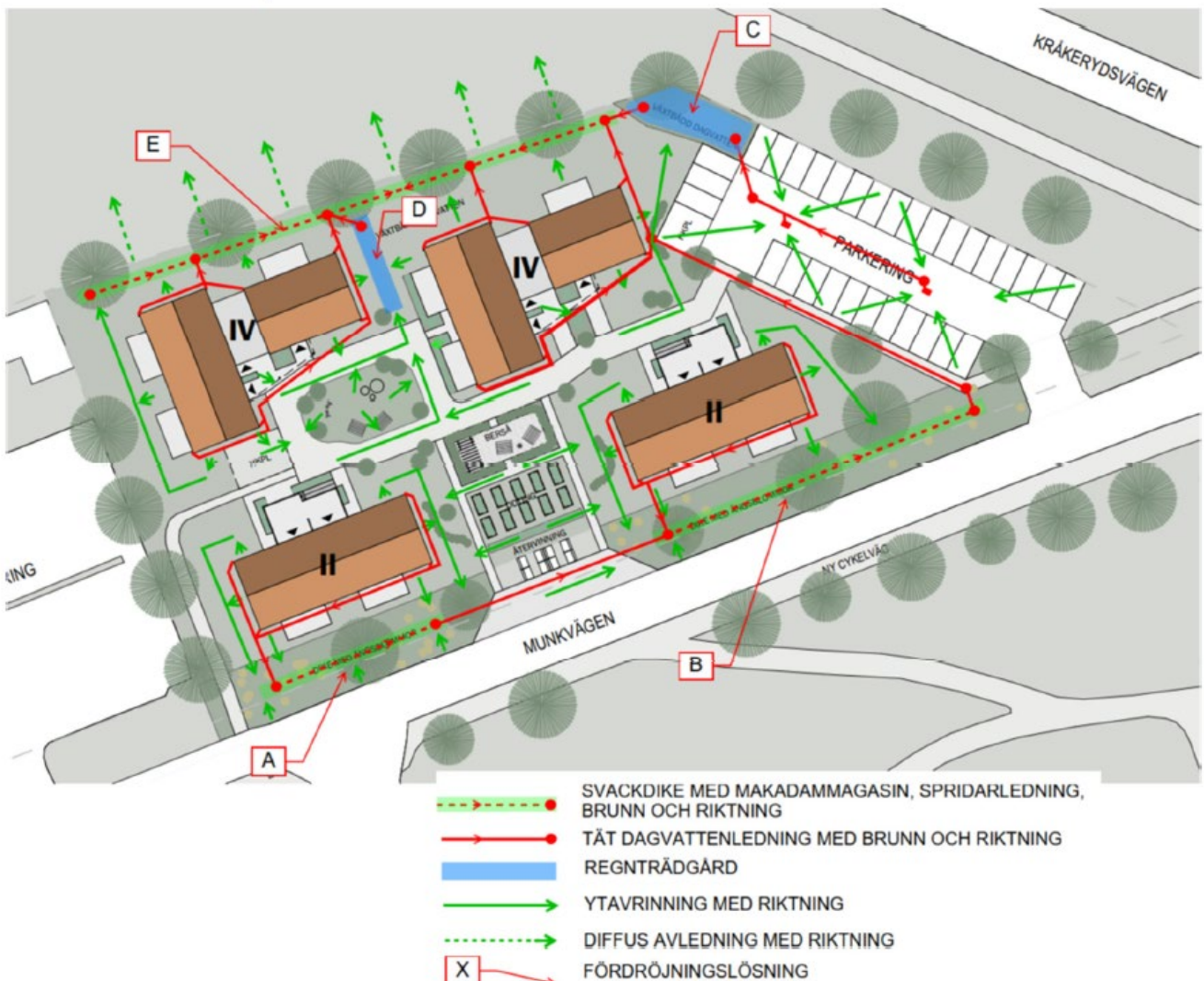
Förslag till dagvattenhantering för avledning, fördröjning, rening och diffus avledning ut från planområdet. Noll Tre Konsult AB
