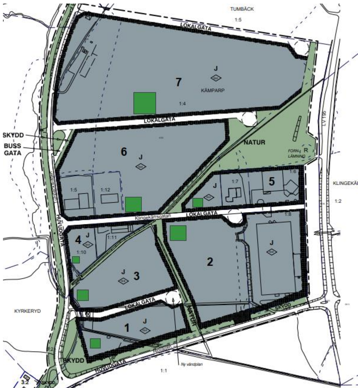
Figur 19. Illustration av nödvändig fördröjningsyta om fördröjningsmagasin byggs med djup 1 m.
