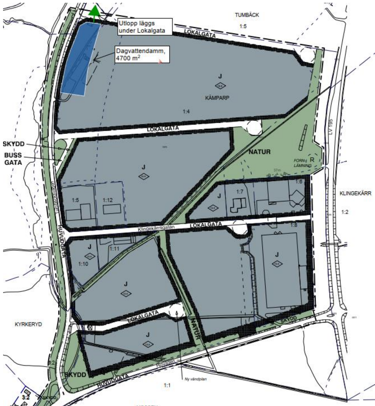
Figur 20. Exempel på var en dagvattendamm skulle kunna placeras, med dammens ungefärliga ytbehov
